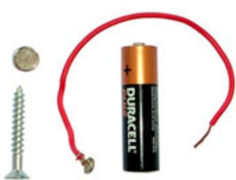
Lo primero que hay que hacer es situar el tornillo entre la pila y el imán, de tal forma que las tres piezas aparezcan juntas por el efecto del imán. Si ponemos en contacto el polo positivo de la pila al tornillo, éste girará en un sentido determinado. Si lo ponemos en contacto con el polo negativo, girará en sentido contrario. Esto se debe al campo que se crea en torno al tornillo, si es positivo o negativo.
