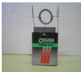
Te proponemos construir un motor eléctrico formado por una pila, un cable arrollado en forma de espira, un imán permanente y dos clips metálicos que harán de soporte de la espira (tal como se muestra en la imagen).
